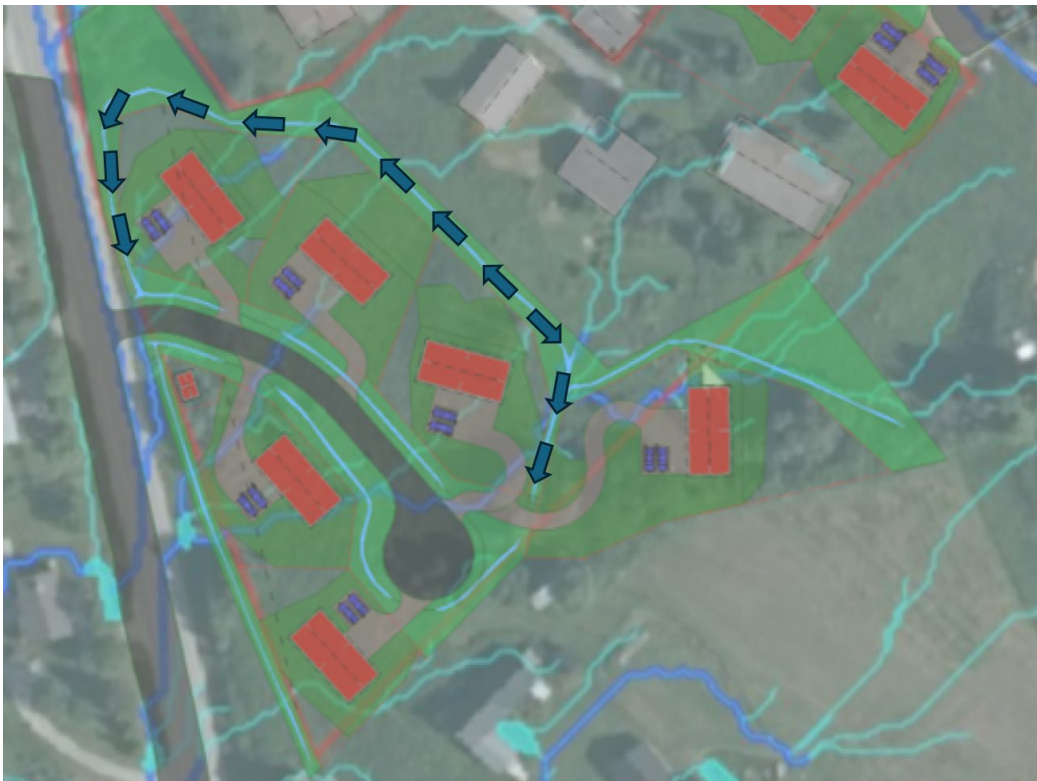
Figur 19 Hantering av dagvatten och naturliga rinnstråk inom planområdet. Ändrad styrning från dagvattenutredning markeras med pilarna.
