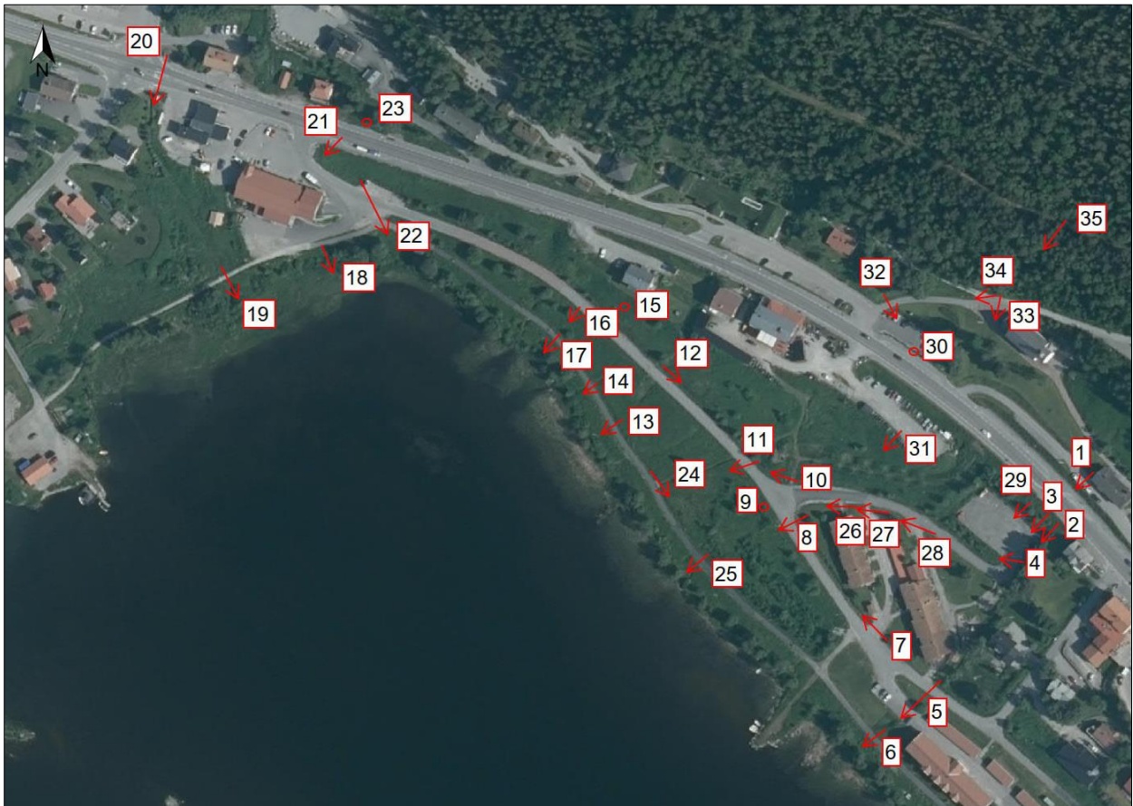
Figur A. Lägen för trummor/ledningar och brunnar som observerades vid fältbesök. Pilar markerar trummor/ledningar och cirklar markerar brunnar.
