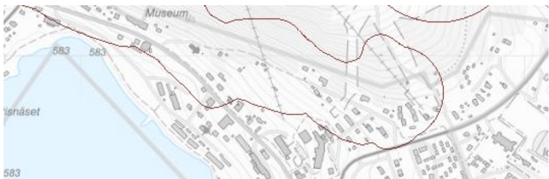
Figur 2 Område som kan påverkas vid ras inringat med mörkbrunt (Skogsstyrelsen).
